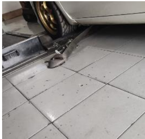
Gambar 3. 11 pemasangan strap ke kendaraan
