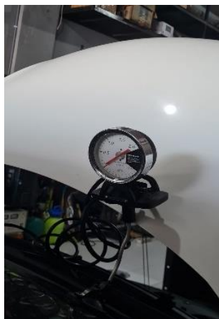
Gambar 3. 9 Boost meter eksternal
