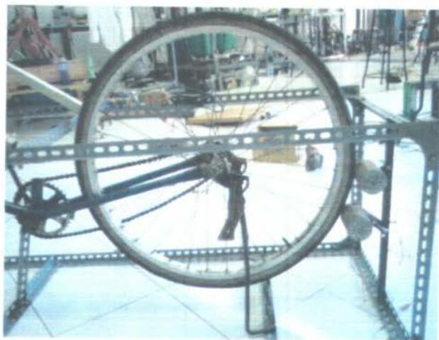
**Gambar Susunan Roda Memutar Generator**
