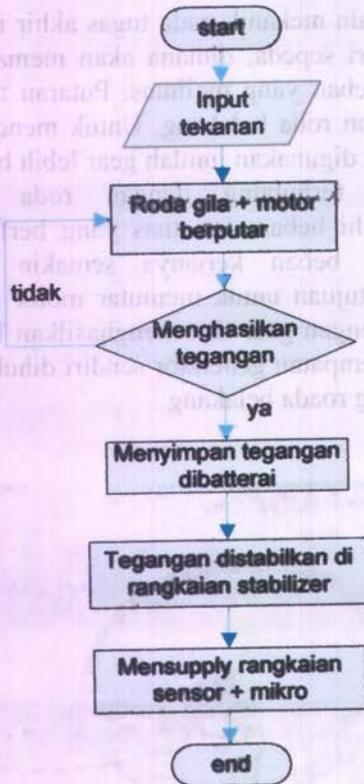
Gambar 3.11 Flowchart mengenai system power untuk alat ukur RPM motor
