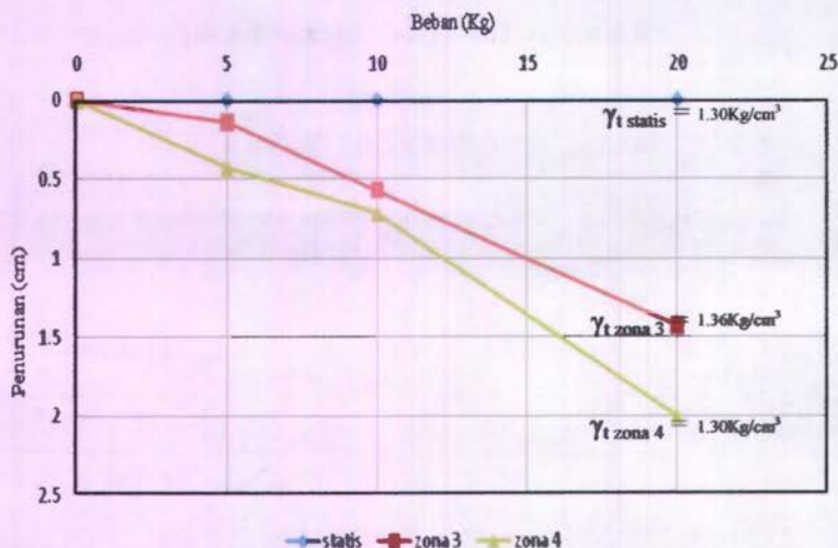
Gambar 4.51 Grafik Pembebanan - Penurunan pada Tanah Uji dengan Indeks Kecairan (LI) = 0.522 pada kondisi beban statis dan dinamis dengan 1 Buis beton diameter = 7 cm.
