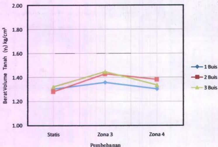
Gambar 4.31 Berat Volume Tanah ( \gamma_t ) pada Tanah Uji dengan Indeks Kecairan (LI) = 0,522 pada kondisi beban statis dan dinamis dengan Buis beton diameter (D) = 7 cm.
