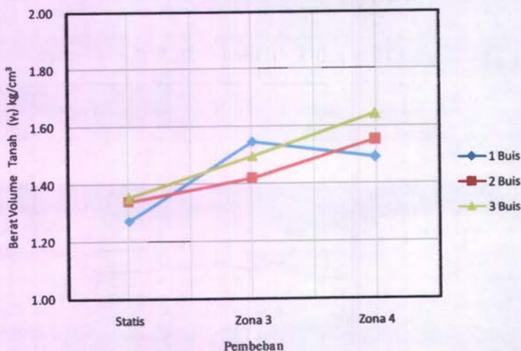
Gambar 4.35 Berat Volume Tanah ( \gamma_t ) pada Tanah Uji dengan Indeks Kecairan (LI) = 1.205 pada kondisi beban statis dan dinamis dengan Buis beton diameter (D) = 10 cm.
