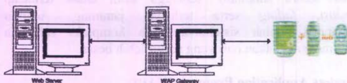
Gambar 2.3 Diagram network pada WAP
