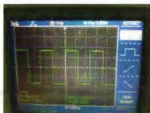
Gambar 4.3 Sinyal kotak dengan frekuensi 81.3 Hz pada output rangkaian H-bridge
