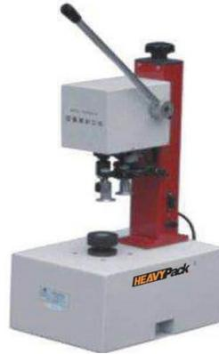
**Gambar 4. 2** Mesin Penutup Botol Manual
