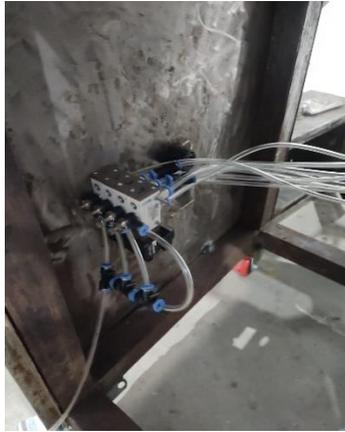
**Gambar 4. 41** Pemasangan Tube pada Komponen Pneumatik
