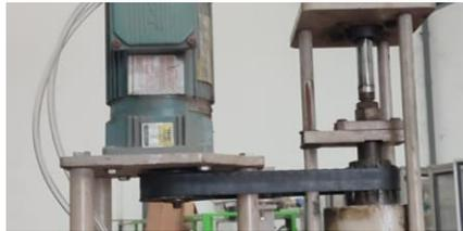
**Gambar 4. 42** Pemasangan Motor Induksi
