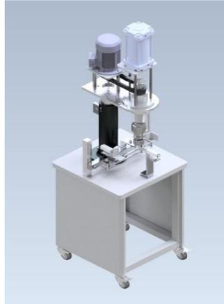
**Gambar 4. 11** Mesin Penutup Botol
