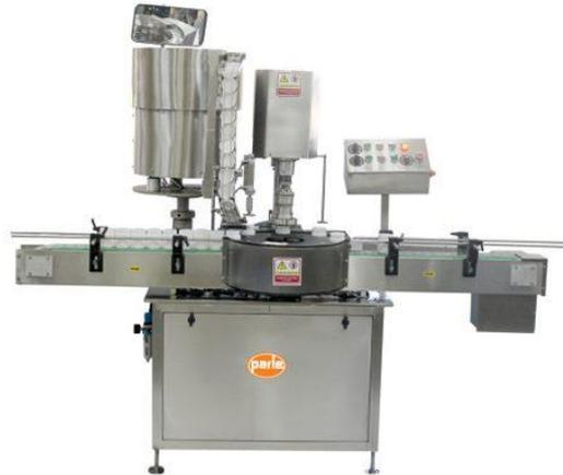
**Gambar 4. 1** Mesin Penutup Botol
