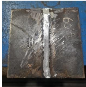
Gambar 4-14. Variasi Kode 60A (HI Rendah 90 Ampere Sudut Umum 60°)
