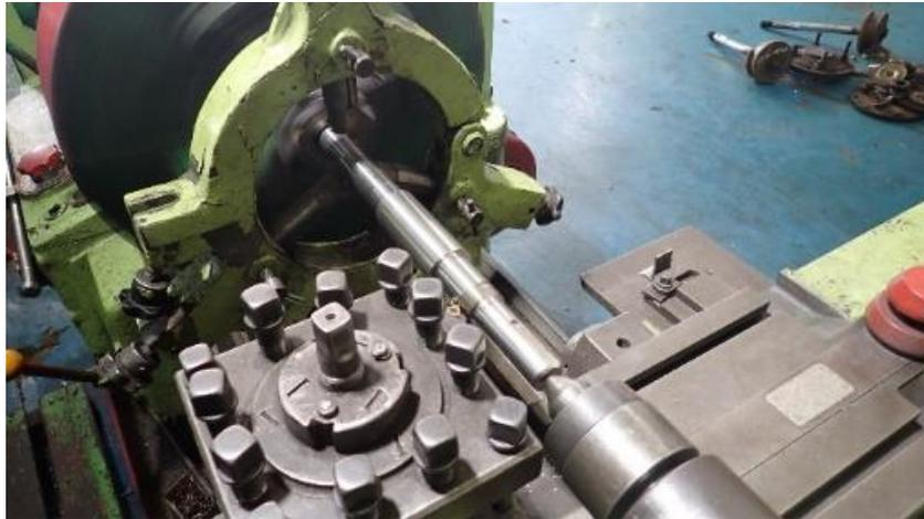
**Gambar 4. 25** Proses Fabrikasi Shaft di Mesin Bubut
