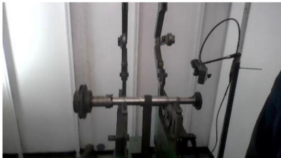
**Gambar 4. 29** *Balancing* pada *Rotor* sesuai API 610
