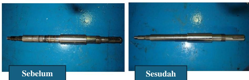
**Gambar 4. 26** Shaft sebelum di Fabrikasi dan Shaft Baru yang sudah di Fabrikasi
