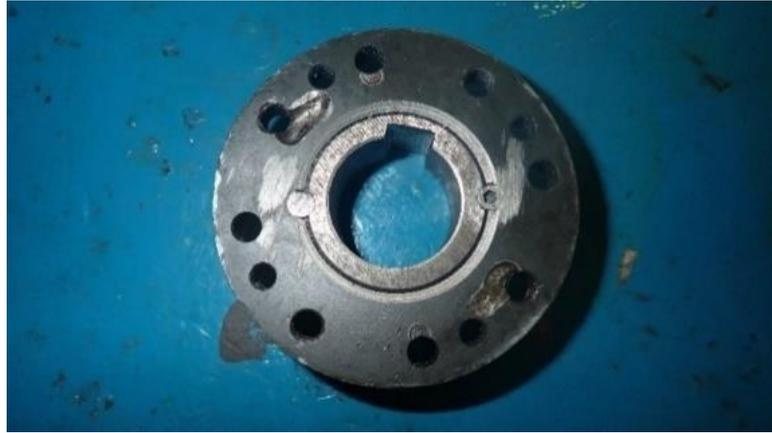
**Gambar 4. 27** *Re- Bushing* pada *Hub Coupling*
