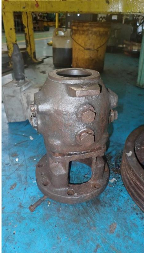
*Housing Bearing Pompa FC-P-754B setelah dibongkar*
