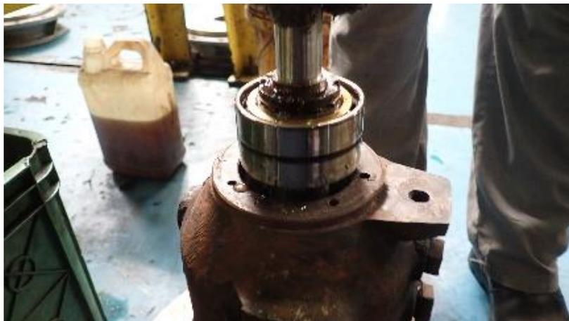
**Gambar 4. 32** Pemasangan *rotor* ke *bearing Housing*
