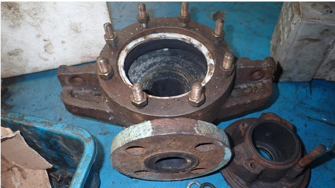
Casing Pompa FC-P-754B setelah dibongkar
