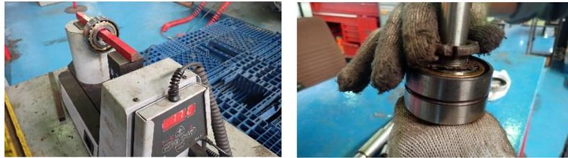
**Gambar 4. 31** Penggunaan *Bearing Heater* dan Mengikat *Bearing* dengan *Lock-nut*
