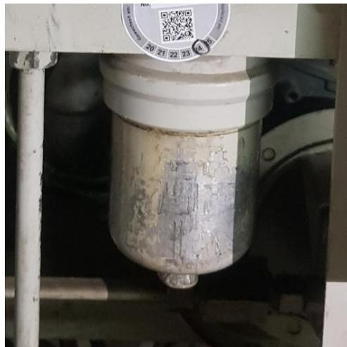
**Gambar 4.21 Oil Filter dengan Non-return valve**
