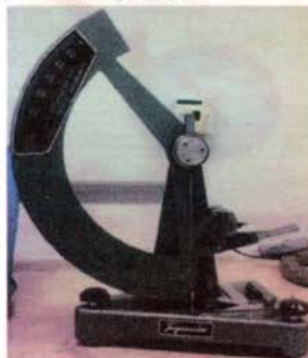
Gambar 3.8 Peralatan Uji Kuat Sobek
