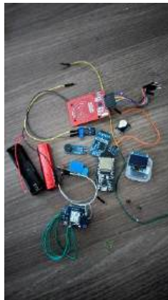
Gambar 4.23 Komponen Sistem Monitoring IoT (Sumber: Dokumen Pribadi)
