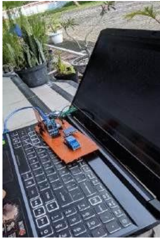
Pengujian akurasi GPS untuk memastikan bisa membaca koordinat yang telah ditentukan
