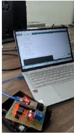
Gambar 4.35 Upload Pemrograman Mikrokontroler ESP32 (Sumber: Dokumen Pribadi)
