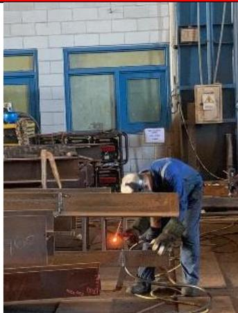
Air Gouging pada Kanal C
