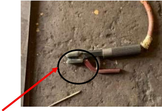
**Gambar 4. 9** Pemegang Elektroda
