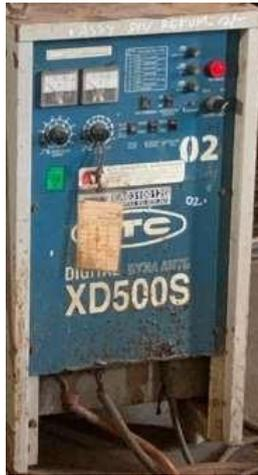
**Gambar 4. 22** Mesin Las GTAW
