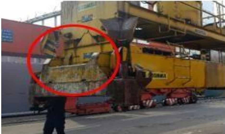
Gambar 4.10 End Beam Spreader Bromma pada Rubber Tyred Gantry (Sumber : Dokumen Pribadi)
