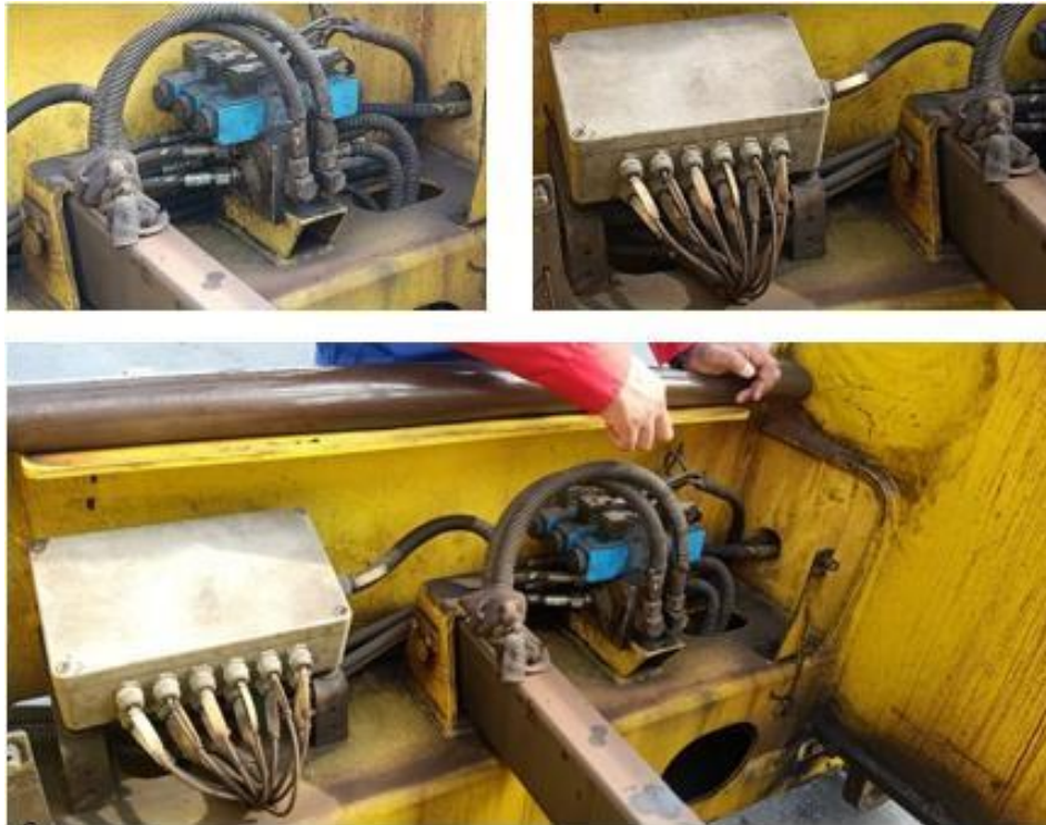
Gambar 4.19 System Control dan Solenoid Valve Twistlock dan Flipper (Sumber : Dokumen Pribadi)
