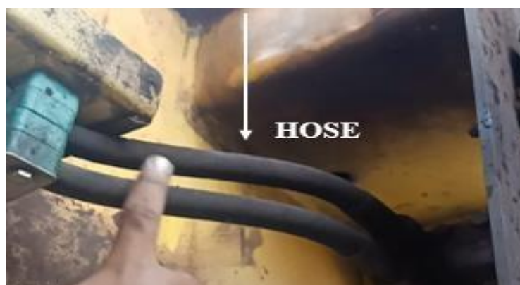
Gambar 4. 22 Hose menuju Teleskopik dari Directional Control Valve (Sumber : Dokumen Pribadi)
