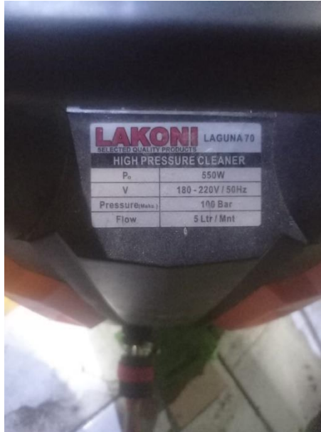
Gambar 4. 25 Pressure Pump (Sumber: Dokumentasi Pribadi)
