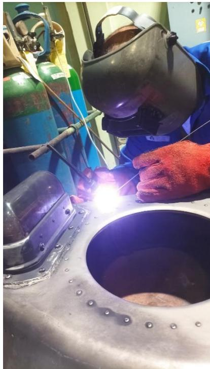
**Dokumentasi :** *Pengelasan nozzle exhouse pesawat menggunakan pengelasan TIG*
