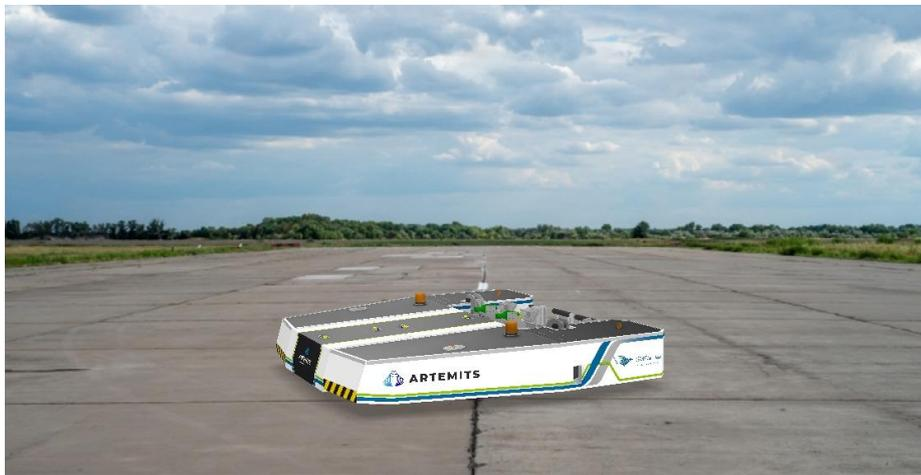
**Gambar 3. 1** Desain ARTEMITS (EV RC Pushback TUG Generasi ke-2)
