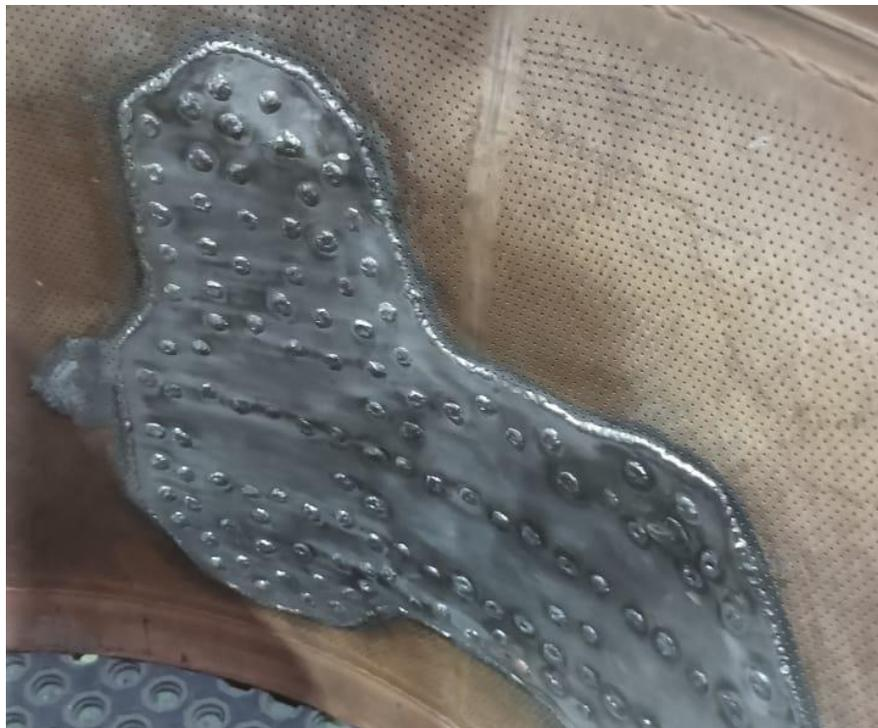
**Dokumentasi :** *Hasil proses pengelasan pada nozzle exhause pesawat yang mengalami retakan*
