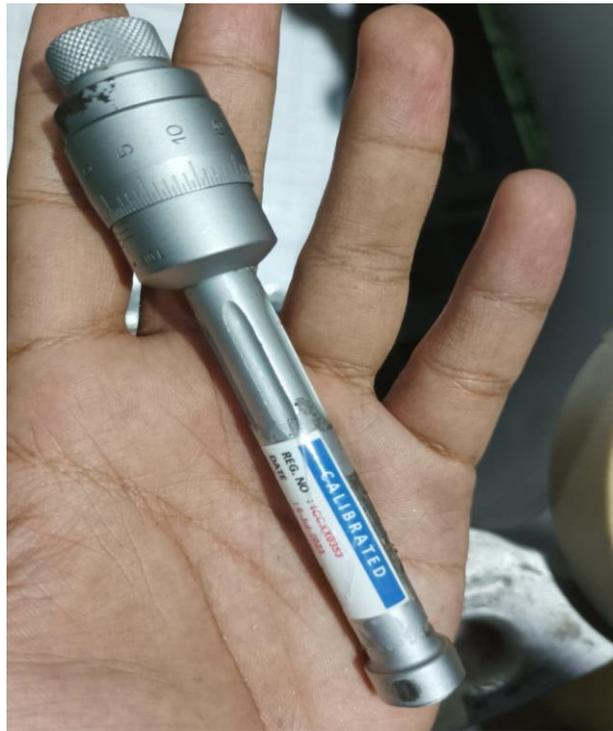
**Dokumentasi :** *Alat ukur yang digunakan untuk mengetahui diameter lubang bushing (Micrometer Screws)*
