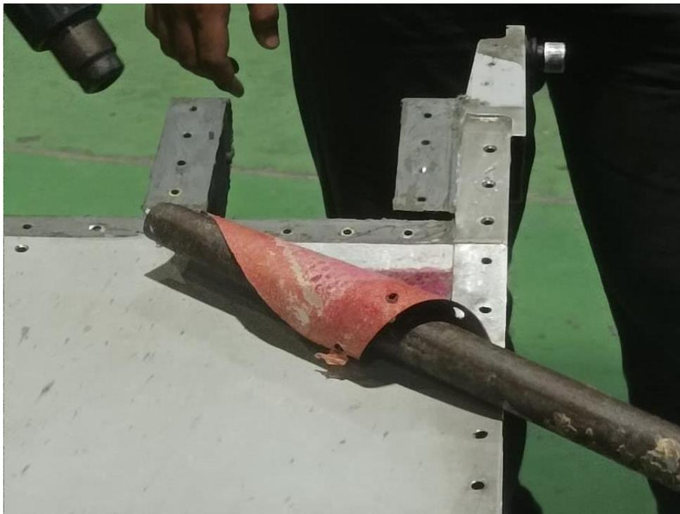
**Dokumentasi :** *Proses Pelepasan Lapisan Terluar Aileron Setelah Dipanaskan dengan Heat Gun*
