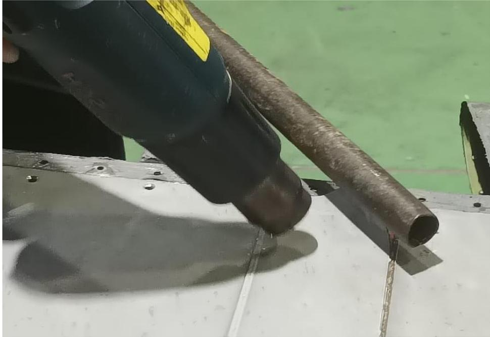
**Dokumentasi :** *Mempelajari Proses Delaminasi Pada Aileron Pesawat (Proses memanaskan lapisan terluar aileron dengan heat gun)*
