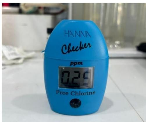
**Gambar 3.3 Hasil Pengukuran Sisa Klor Alat *Portable***
