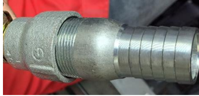
Gambar 4. 12 Sambungan selang radiator (Sumber: Dokumentasi Pribadi)
