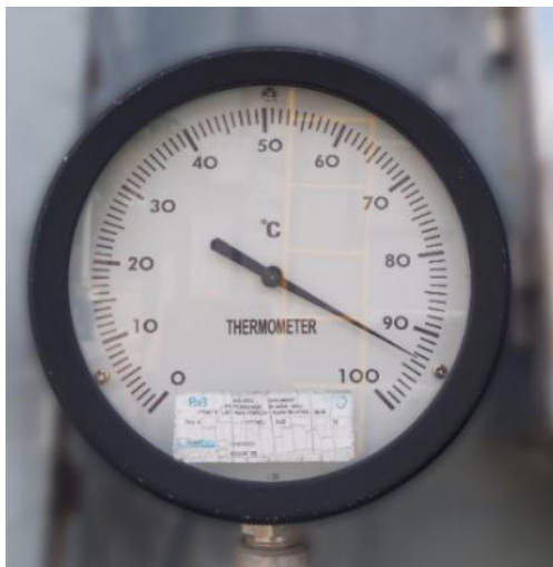
Gambar 4. 40 Nilai Temperatur Motor Sebelum Overhaul
