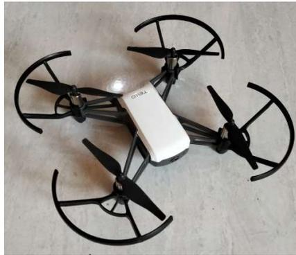
Gambar 3.2 Drone DJI Ryze Tello
