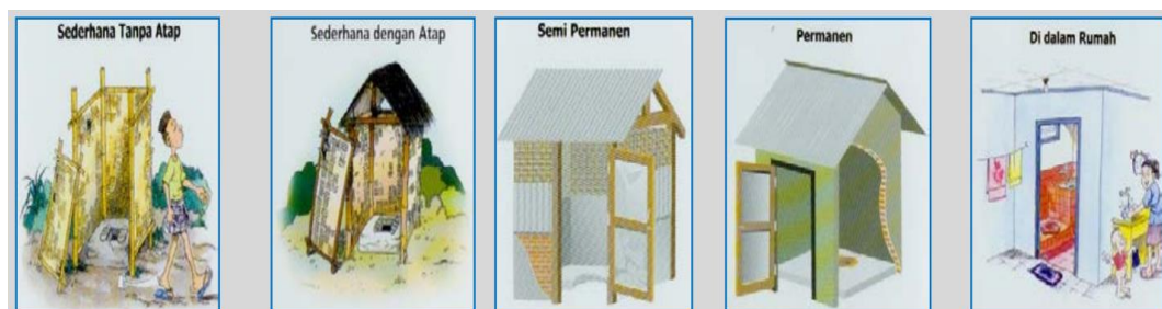
Gambar 2.7 Bangunan atas jamban
