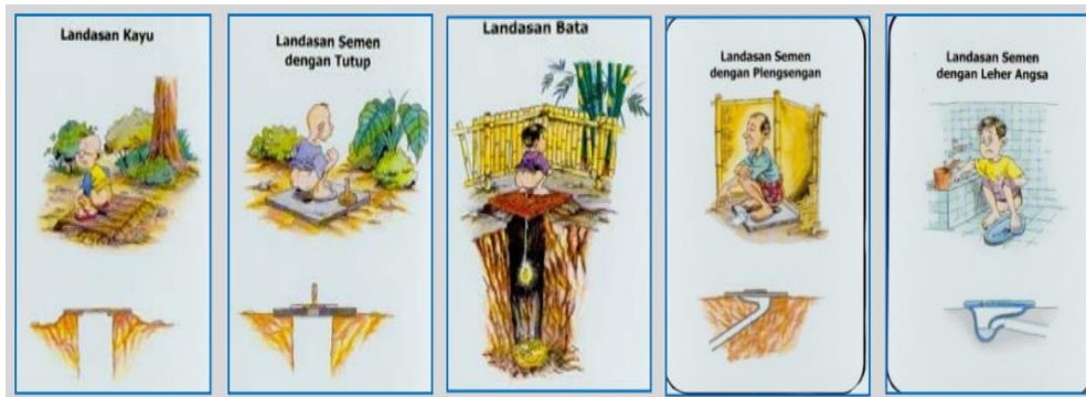
Gambar 2.8 Bangunan Tengah jamban
