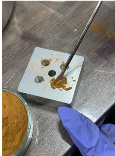
Gambar 2. Proses pembuatan briket sampel
