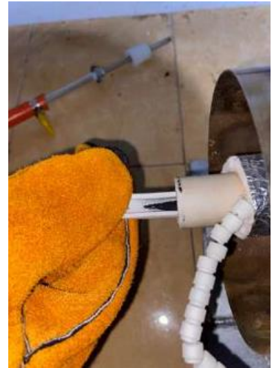
Gambar 9. Proses pengeluaran sampel hasil reduksi dari dalam furnace
