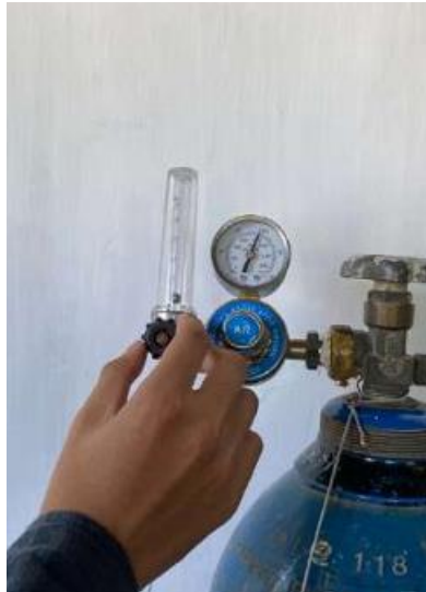
Gambar 7. Proses pengaturan laju alir gas nitrogen ( N_2 )
