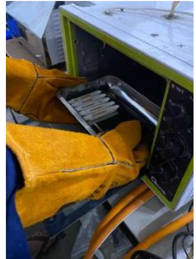
Gambar 3. Proses pengeringan bijih nikel laterit menggunakan oven
