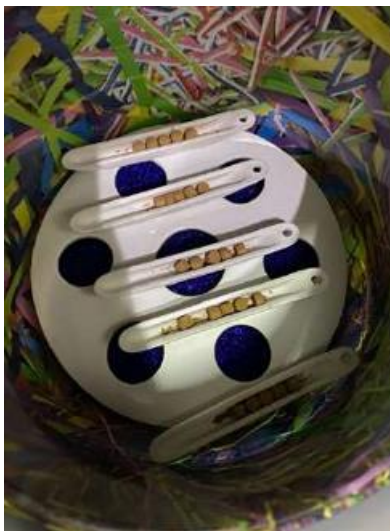
Gambar 4. Briket bijih nikel laterit kering diletakkan dalam dessicator
