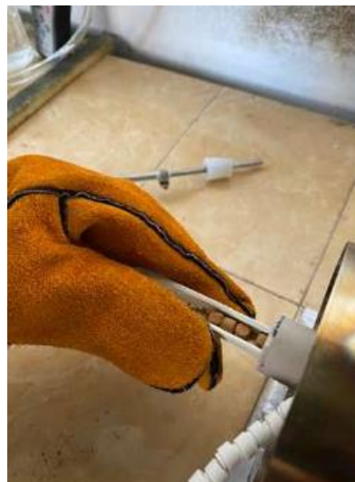
Gambar 5. Proses memasukkan bijih nikel laterit ke dalam furnace
