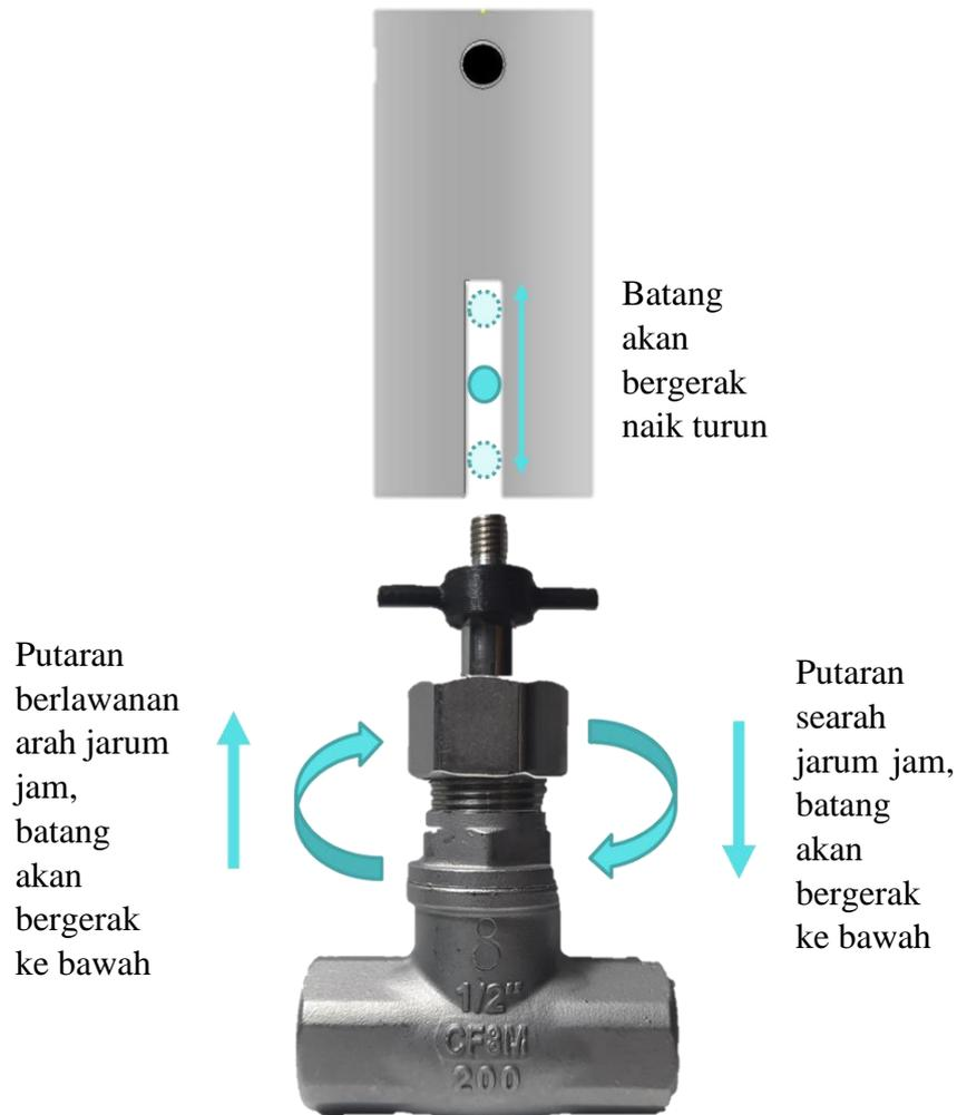
Gambar 3.4 Mekanisme Pergerakan *Globe Valve*
