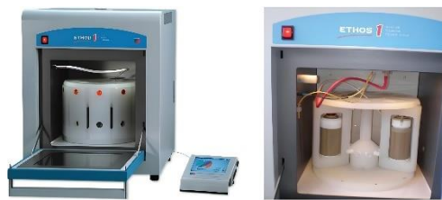
Gambar 2.21 Tungku Milestone Ethos One komersial untuk sintesis microwave assisted hydrothermal (Ortiz Méndes et al, 2016)
