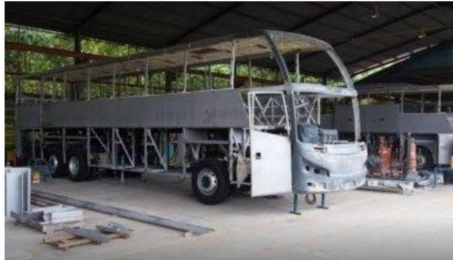
Gambar 2.5 Hasil Pemasangan Panel
