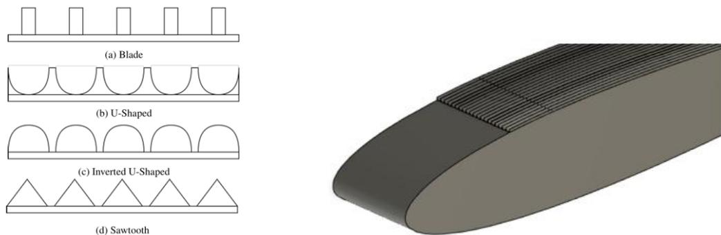
**Gambar 2.19** Profil Riblet dan Pengaplikasian pada NACA 0012 (Tyagi et al, 2023)
