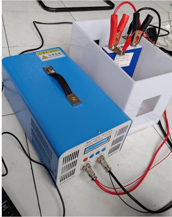
Gambar 3.7 Pemasangan Battery Tester pada Baterai
