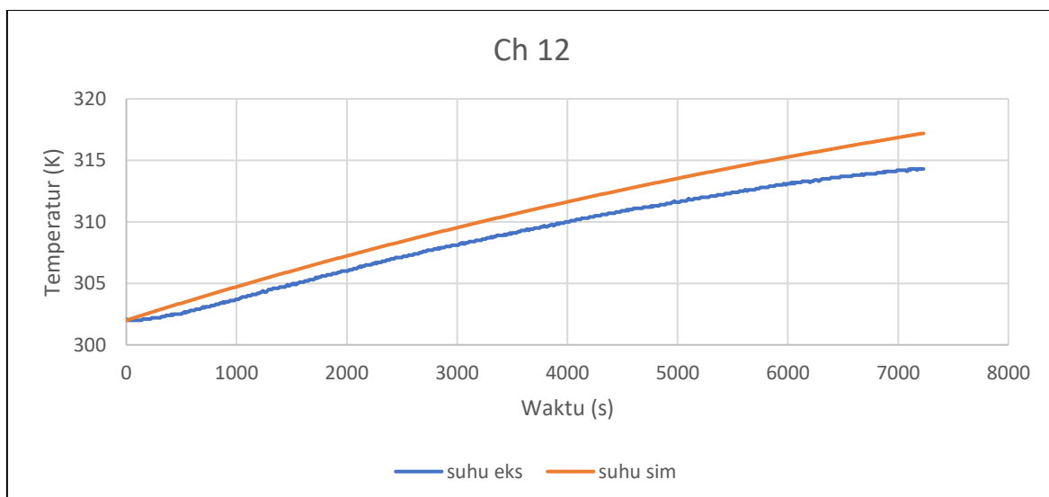
Gambar 4.5 Grafik Perbandingan Temperatur Eksperimen dan Simulasi pada Variasi Konveksi Natural 2 cm
