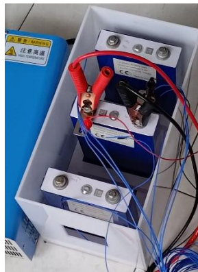
Gambar 3.8 Pemasangan DAQ pada Permukaan Baterai
