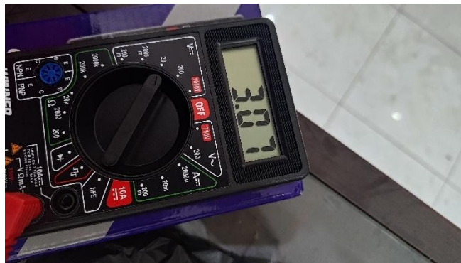
Gambar 3.6 Baterai dalam Kondisi Tidak Siap Digunakan
