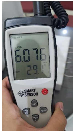
Gambar 3.4 Pengukuran Kecepatan Aliran Udara pada Fan
