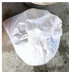
Gambar 3. 6 Pengondisian SSD Agregat Kasar
