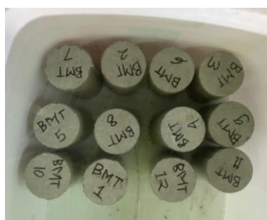
Gambar 3. 11 Proses Curing Beton dalam Air
