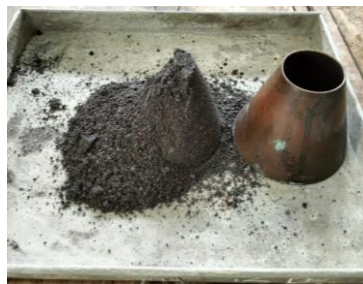
Gambar 3. 7 Pengondisian SSD Agregat Halus
