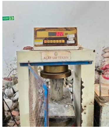
Gambar 3. 16 Pengujian Kuat Tekan Beton
