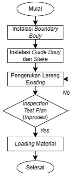
Gambar 7.15 Diagram Alir Pekerjaan Excavation STA 0+00
