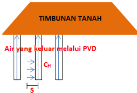
Gambar 2.15 Pemampatan dengan Menggunakan PVD
