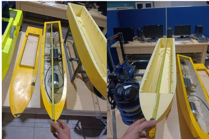
Gambar 5. 34 Pengukuran panjang model kapal fiber dan hasil fisik
