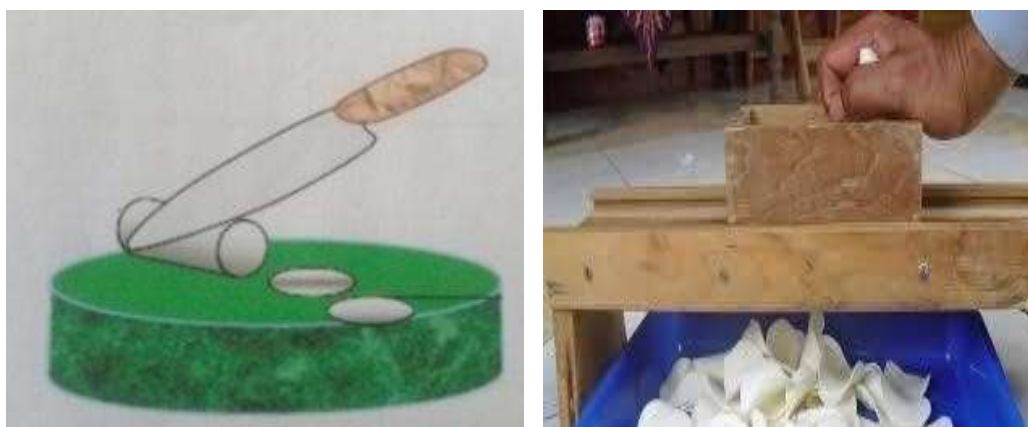
Gambar 2. 3 Proses Pemotongan Metode Konvensional (Eswanto et al., 2019)
