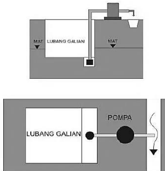
Gambar 2.3 Ilustrasi dewatering open pumping (Sumber : Asiyanto, 2008).
