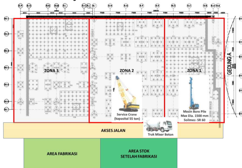
Gambar 4.57 Layout dan Sequence Pekerjaan Pondasi
