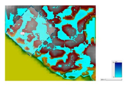
Gambar 5.2 Genangan dengan curah hujan = 100 mm, waktu hujan = 1 jam, tinggi genangan = 0,52 m
