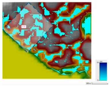
Gambar 5.3 Genangan dengan curah hujan = 30 mm, waktu hujan = 1 jam, tinggi genangan = 0,26 m
