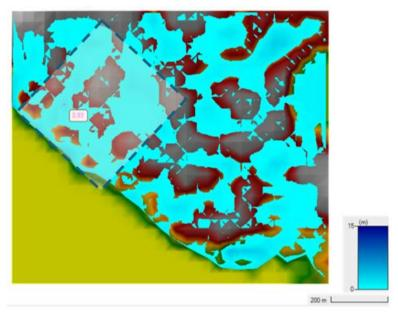
Gambar 5.4 Genangan dengan curah hujan = 167,5 mm, waktu hujan = 1 jam, tinggi genangan = 0,93 m
