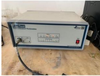
Gambar 3.15 Alat instrumen EIS (Dokumentasi pribadi)
