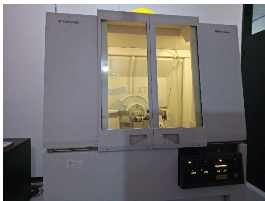
Gambar 3.9 Alat instrumen XRD (Dokumentasi Pribadi)
