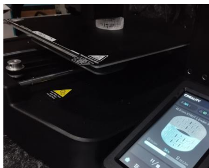
Gambar 3.13 Proses Pencetakan Auxetic Tube
