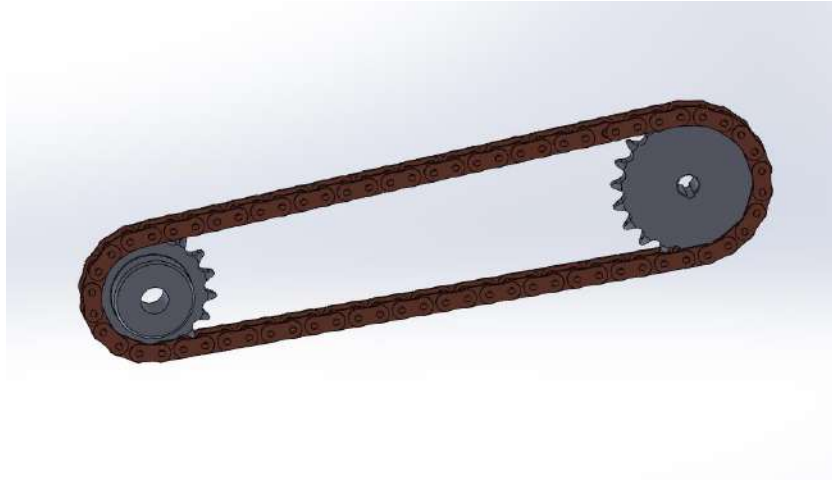
Gambar 4.33 Desain 3D chain sprocket RS80 20T dan 17T
