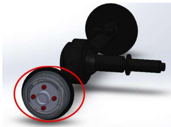
Gambar 4.52 Drum Brake pada Differential Gear
