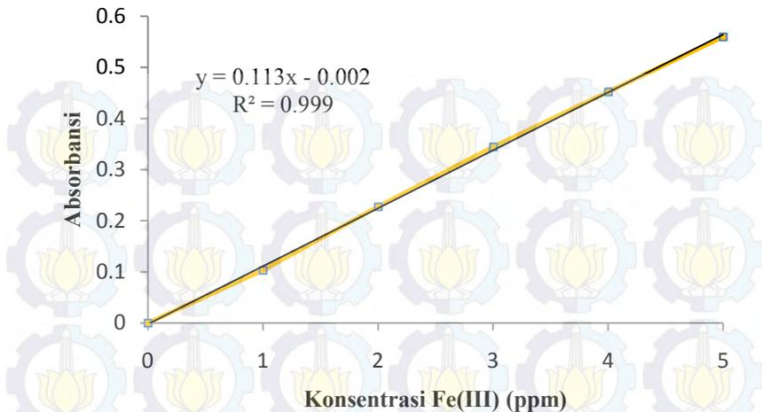
**Gambar 4.3 Kurva Kalibrasi  $[\text{Fe}(\text{fenantrolin})_3]^{2+}$  pada Panjang Gelombang Maksimum 510 nm**
