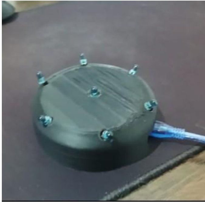
Gambar 4.18: Hasil perakitan alat IR Blaster
