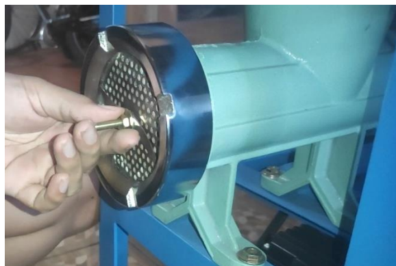
Gambar 4. 10 Proses Pelepasan dan Pemasangan Dies Modular
