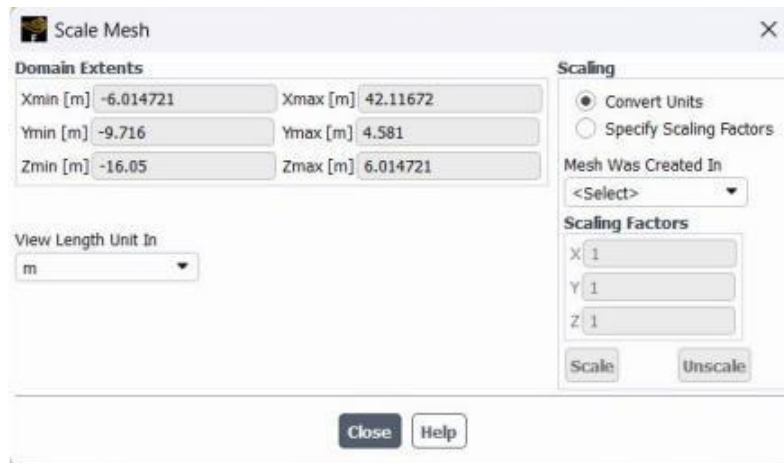
Gambar 4. 41 Scale Mesh pada Ansys CFD
