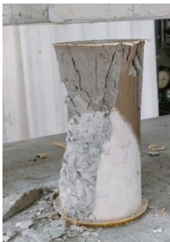
(a) Tidak rusak di pertemuan layer
