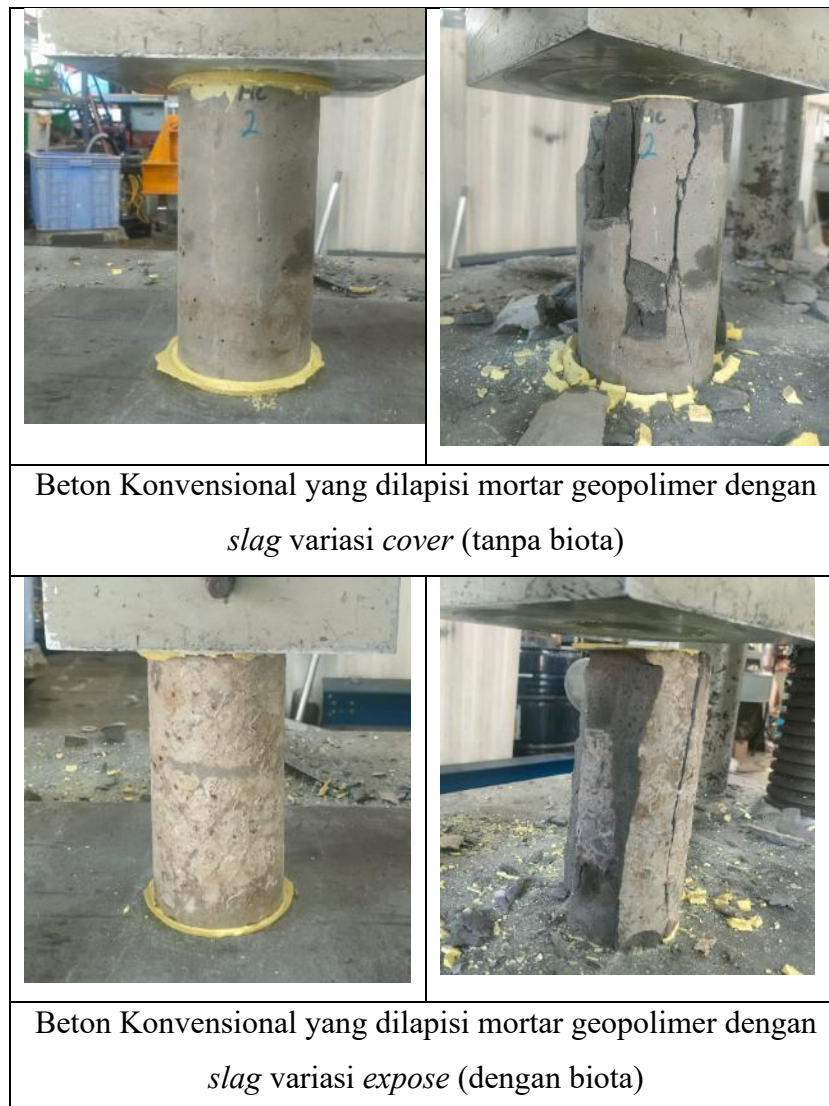
Gambar 7.1 Pengujian Tekan Beton pada umur 370 hari (342 hari perendaman)
