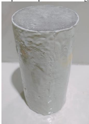
(c) Sampel yang dilapisi sikagard dengan biofouling
