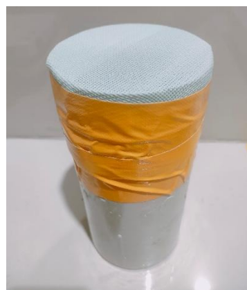
(d) Sampel yang dilapisi sikagard tanpa biofouling
