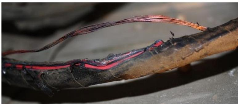
**Gambar 2.2** Kabel listrik yang mengalami kerusakan isolasi akibat pemanasan (sumber: <http://www.news.tridinamika.com/>)
