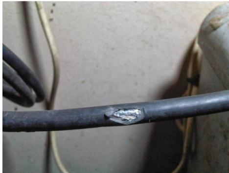
**Gambar 2.3** Kabel listrik yang mengalami kerusakan isolasi akibat gigitan tikus (sumber: <http://1.bp.blogspot.com/>)
