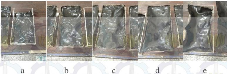
Gambar 4.4 Membran komposit PVA/kitosan/grafin oksida tipe 1 (a), tipe 2 (b), tipe 3 (c), tipe 4 (d), dan tipe 5 (e) setelah pengikat silang dengan trisodium sitrat
