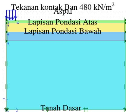
Gambar 4.1 Pemodelan perkerasan lentur 3 lapisan
