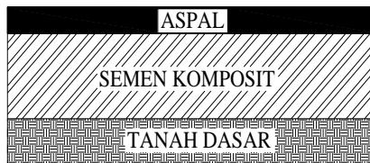
Gambar 2.2 Komponen Perkerasan lentur 2 lapisan (*flexible pavement*)
