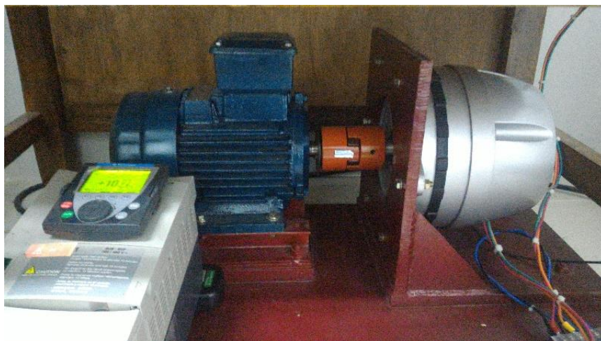
Gambar 3. 3 Emulator Berbasis Laboratorium Sistem Turbin Angin dan PMSG.
