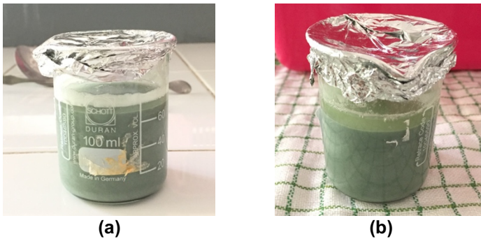
Gambar 3. 2 Proses Perendaman Zeolit dengan Larutan HCl 15% (a) Awal Perendaman dan (b) Setelah 24 Jam
