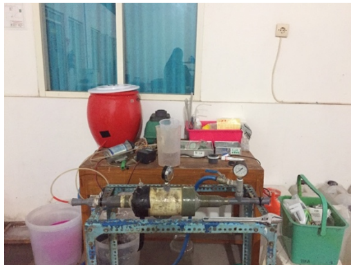
Gambar 3. 11 Sidestream Membran Bioreaktor dengan Aliran Cross-flow
