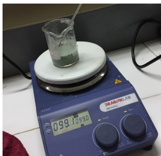
Gambar 3. 6 Proses Pemanasan Zeolit, PVA, dan PEG Menggunakan Hot Plate
