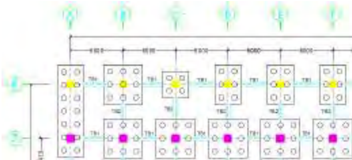
Gambar 8.1 Letak Pondasi Kolom Yang Ditinjau
