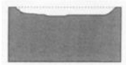
Gambar 2.9 Skema penyerangan uniform corrosion [10]
