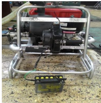
Gambar 3.32 Kipas pada cold EGR dihubungkan dengan baterai
